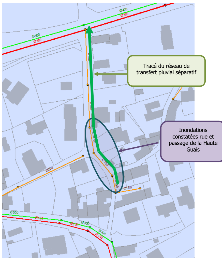
Figure 11 : Principe de desserte eaux usées / eaux pluviales – rue et passage de la Haute Guais – Bassin de collecte de Port Nican
