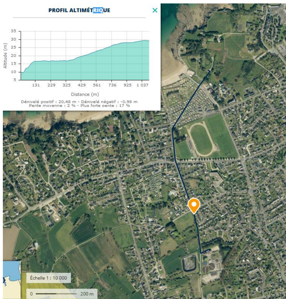
Figure 24 : Tracé et profil indicatif du refoulement actuel de Port Blanc
