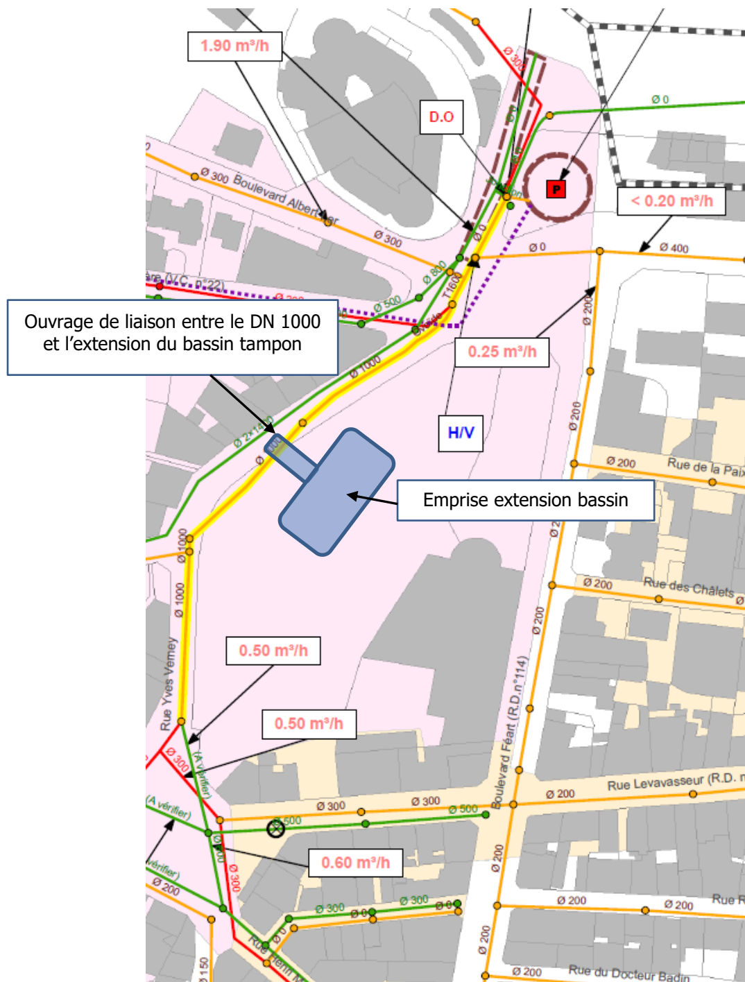
Figure 45 : Implantation d'un nouveau bassin tampon – PR Ecluse
