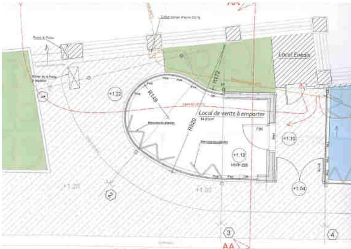
Le local fait 14 m<sup>2</sup> environ, il est isolé et sera alimenté en eau, électricité, téléphonie et gaz. Une évacuation des eaux usées raccordée à un bac à graisse est prévue.
