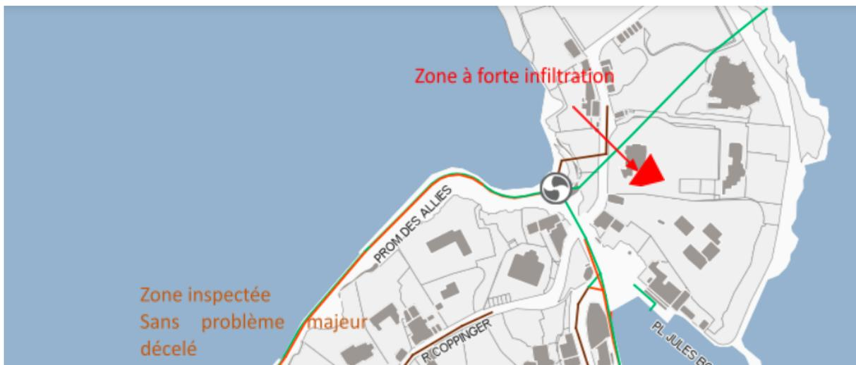
Une inspection avec une caméra en début de marée haute de fort coefficient a été ensuite réalisée et a permis de mettre en évidence toute une zone où le réseau est en mauvais état et où l'eau de mer s'infiltré. Une réhabilitation de ce réseau sera proposée dans le cadre d'une fiche spécifique.
