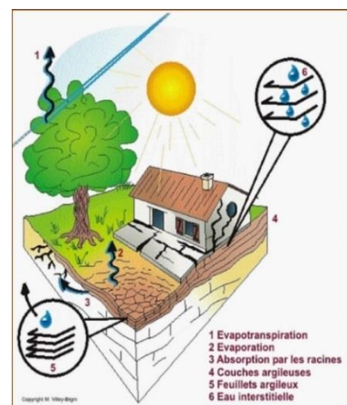
Schéma illustrant le phénomène retrait-gonflement des argiles et ses conséquences sur le bâti (Source : BRGM)
